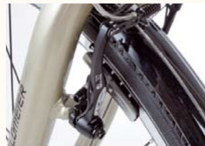
Rückseitig, sprich auflaufend montiert – so bringt die V-Bremse noch bessere Verzögerung.
